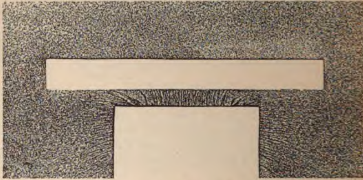
Abb. 203. Elektrodynamische Schirmwirkung einer Kupferplatte.
